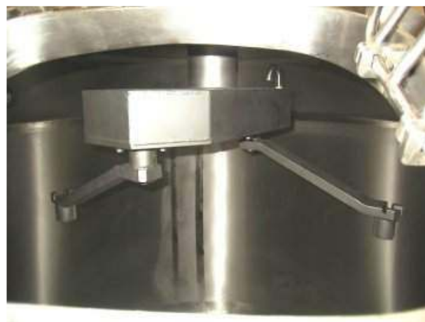
内部の攪拌機アーム部
